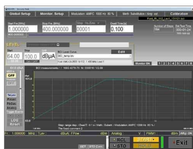
ПО: настройка испытаний на помехоустойчивость
