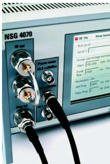
Передняя панель NSG 4070 с радиочастотными портами
