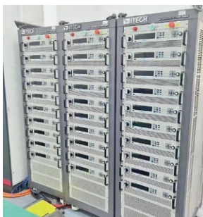
Рис. 8. Тестирование литий-ионных накопителей энергии
