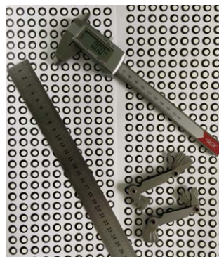
Ручные инструменты измерения — штангенциркуль и резьбомер
