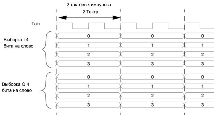
Рисунок 12-4. Синхронизация тактовых импульсов и выборок для конфигурации параллельного порта
