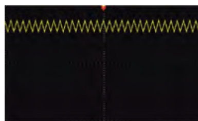
DC+AC V dc =50 В, треугольные пульсации V ac =5 В, частота 1000 Гц
