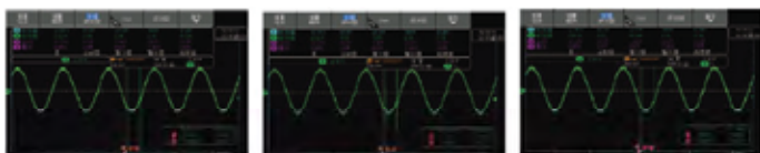
После параллельного подключения 3-х комплектов устройств IT7600, испытательный ток будет распределен между ними в равной степени
