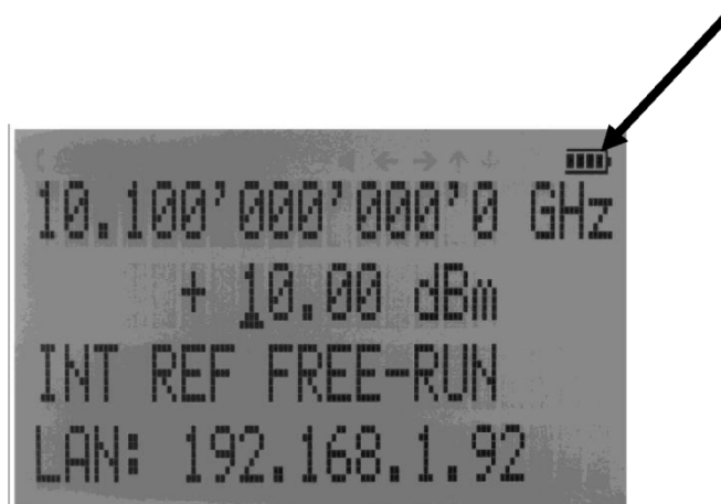
Рис. 22-а. Экран CW режима с символом аккумуляторной батареи
