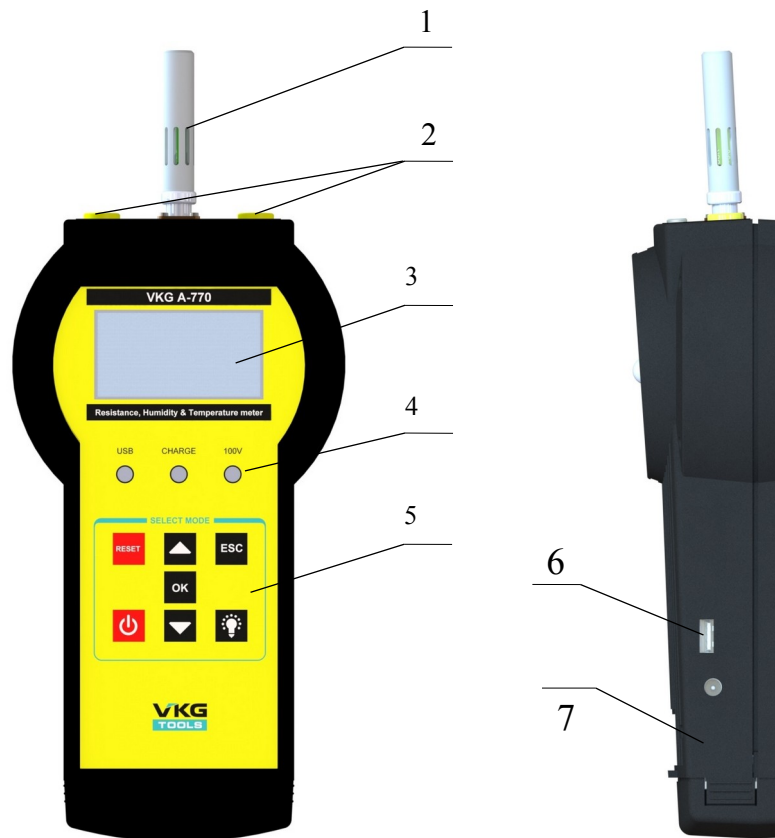
Рисунок 2 – Основные элементы управления и индикации VKG A-770
